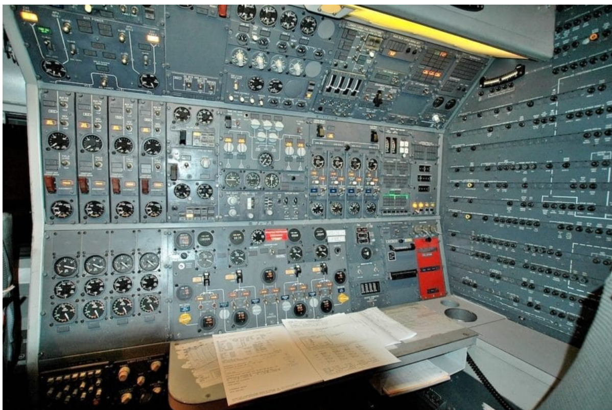
Le large et complexe tableau à bord du 747-200. D'un seul coup d'œil, l'OMN surveillait la bonne santé de l'avion sur toutes les phases du vol. © Cominac
