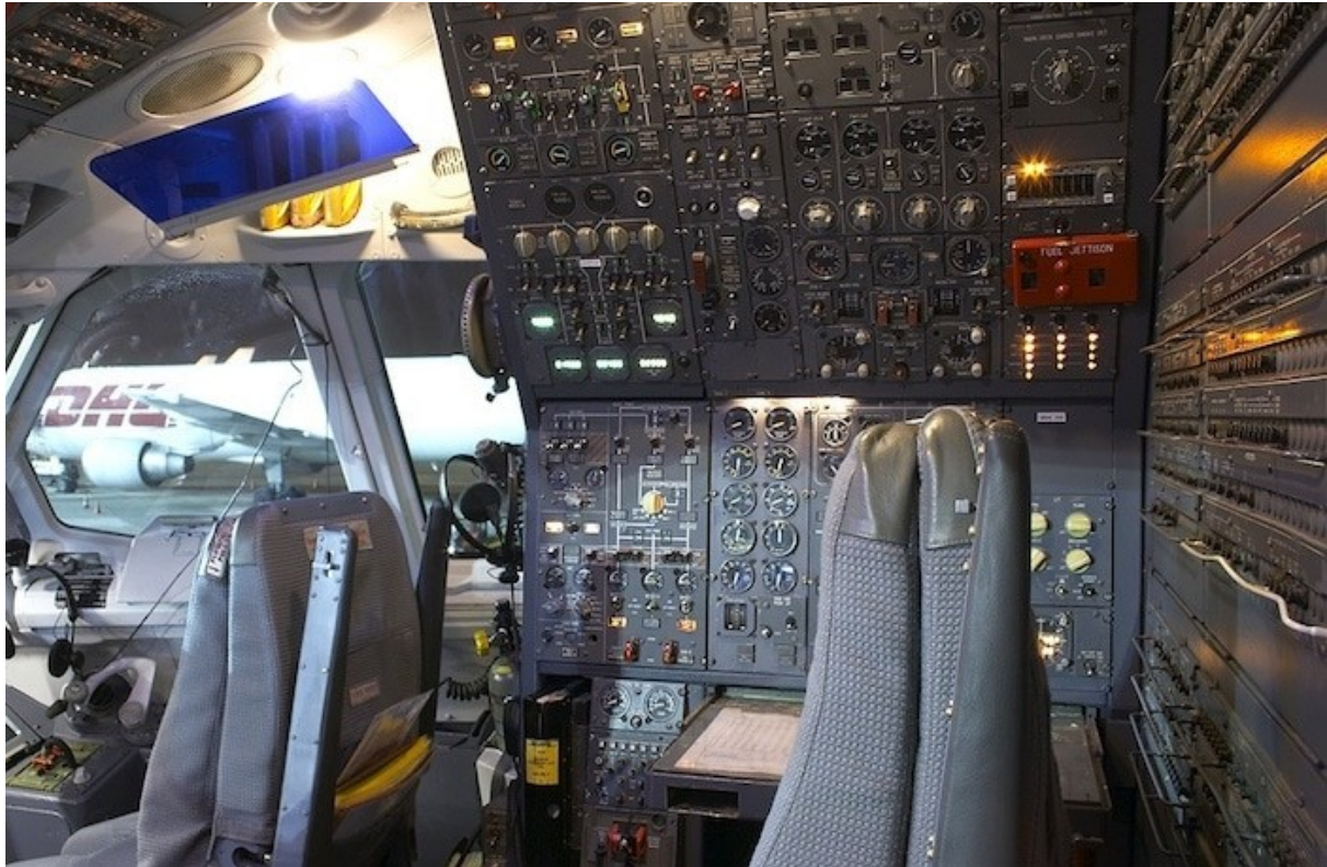
Place OMN à bord de l'Airbus A300-B4 (similaire au poste du Beluga) © Cominac
